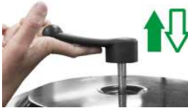
Sacudidor de filtro sistema de limpieza
