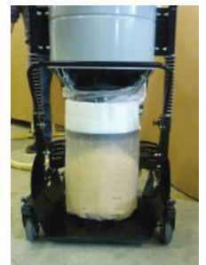
3 Kit LONGOPAC para la descarga del producto en bolsa continua
